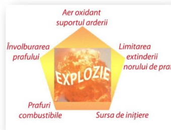
Pentagonul aprinderii la prafurile combustibile
