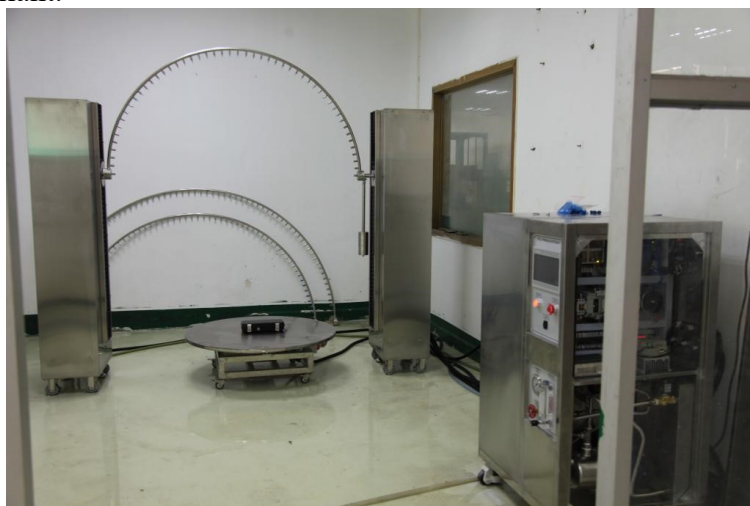
Stand de încercare privind protecția la apă a echipamentelor
